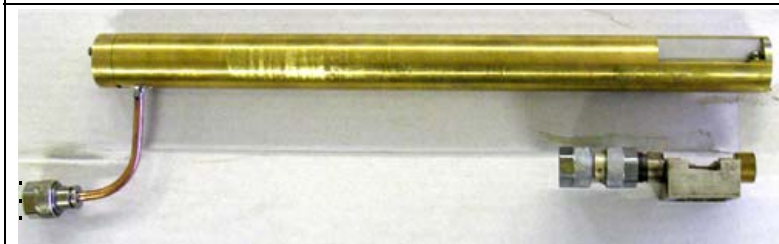
Полосковые измерительные ячейки для измерения магнитной проницаемости тонких ферромагнитных пленок
