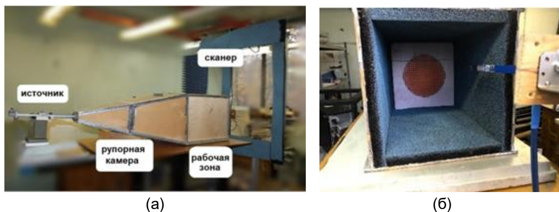
Рисунок 1 – Фото экспериментальной установки: (а) – вид сбоку, (б) – вид спереди
