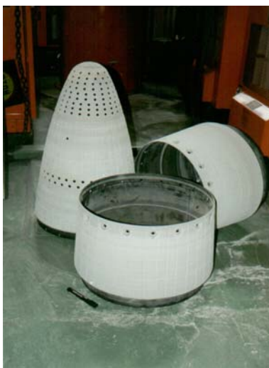
Элементы форсажной камеры авиационного двигателя с покрытием
