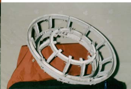
Элементы форсажной камеры авиационного двигателя с покрытием
