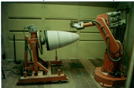
Нанесение покрытия на затурбинный кок авиационного двигателя
