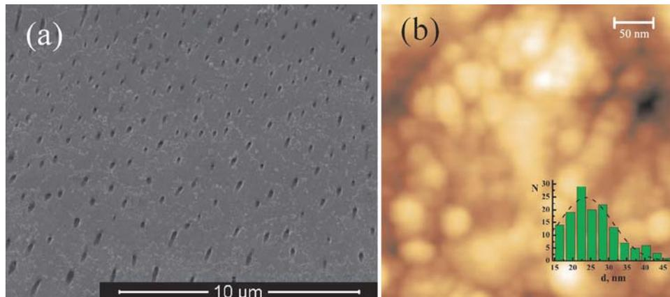
Изображение (a), полученное на сканирующем электронном микроскопе, иллюстрирует наличие включений  $\text{MnSb}$ , (b) – увеличенное изображение включения  $\text{MnSb}$ , полученное с помощью атомно-силового микроскопа. Включение представляет собой кластер наногранул различных размеров. На вставке показано распределение наногранул по размерам, аппроксимированное гауссовой функцией.
