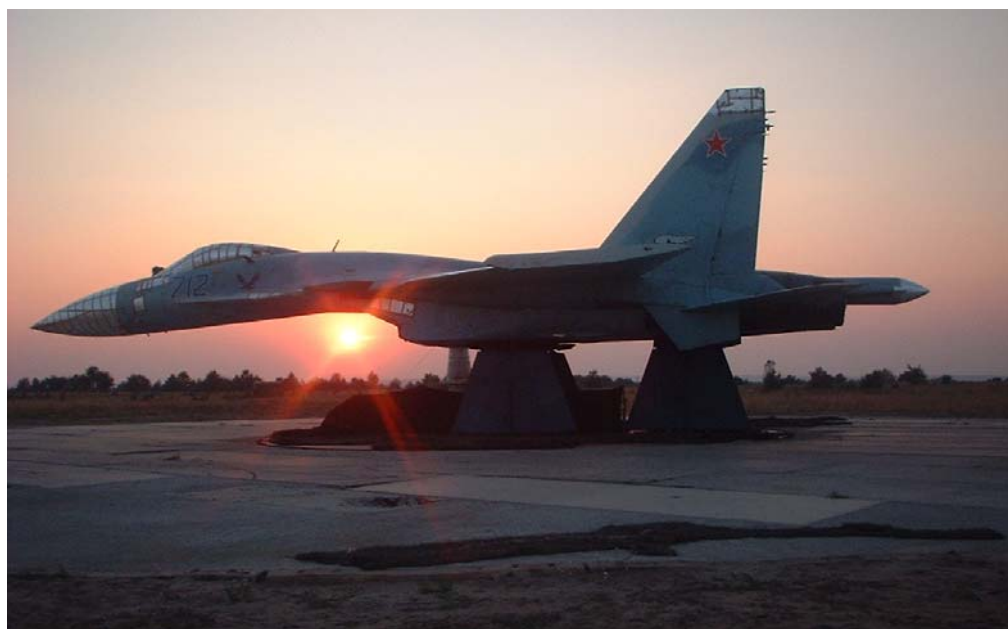
Рис. 25. Самолет на открытом измерительном стенде в ходе испытаний
