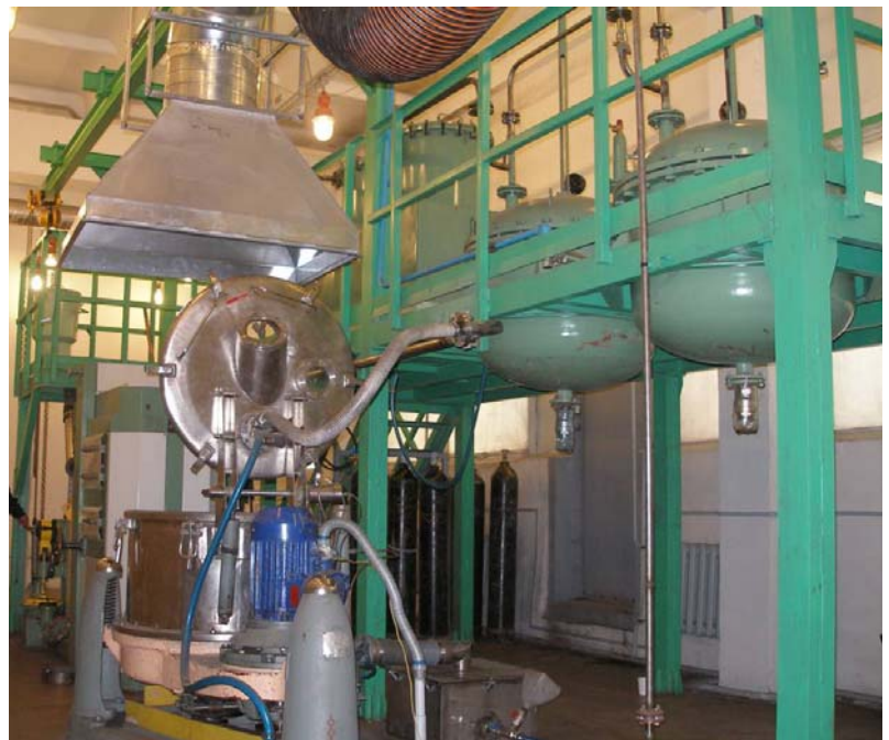
Рис. 21. Технологическая линия для производства магнитного наполнителя РПП
