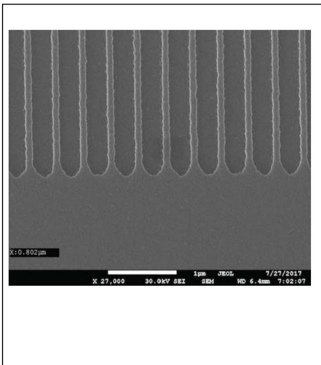
**Рис. 3** Растровое электронное изображение ГКР сенсора, состоящего из гребенчатой кремниевой структуры с нанесённым нано-слоем серебра; период  $L = 400$  нм, высота гребней  $70 \div 90$  нм, толщина серебряного покрытия  $21$  нм
