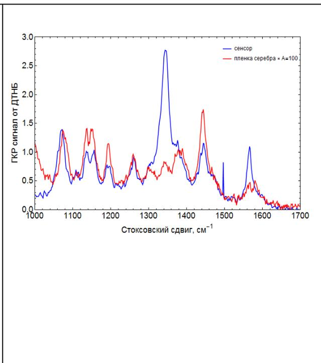
**Рис. 4** Сигнал комбинационного рассеяния от сенсора (синяя линия) в сравнении с сигналом от такого-же количества молекул ДТНБ распределенных на поверхности плоской пленки серебра.
