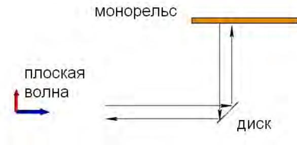
Рисунок 4 – Схема взаимодействия диска и монорельса тельфера в АИК КП
