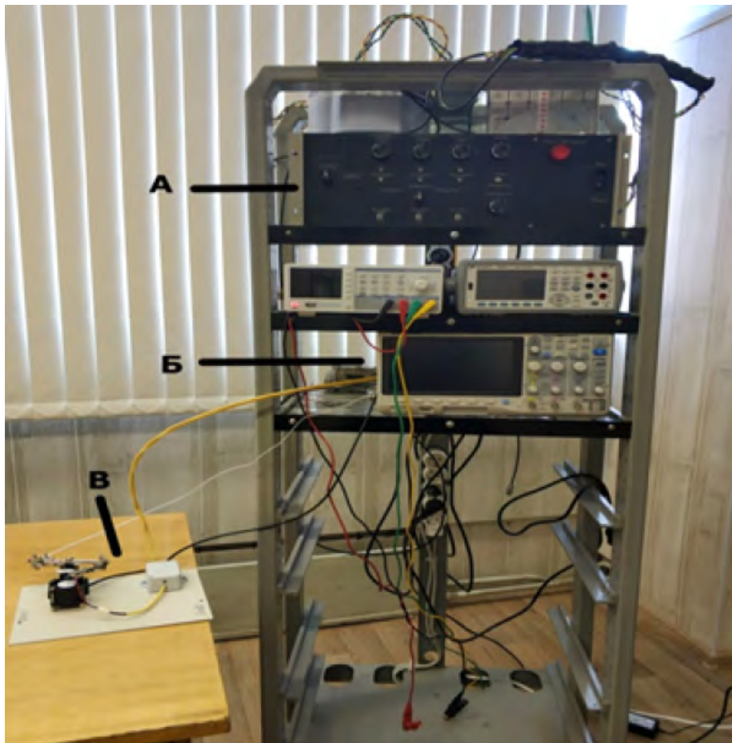
Рисунок 1 – Ультразвуковая установка, состоящая из генератора (а), осциллографа (б), пьезо-элемента с воздушным охлаждением (в), на котором располагалась подложка с аналитом
